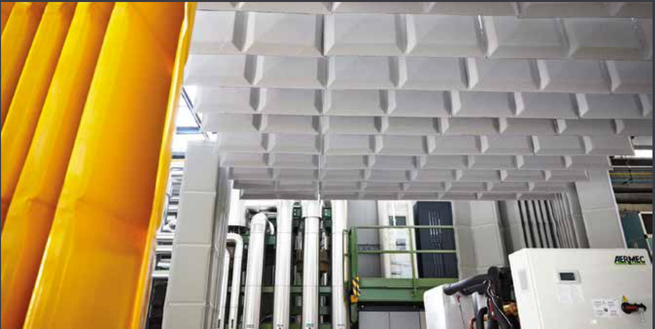
Cámara de pruebas para unidades de condensación por agua
